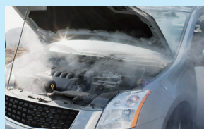
冷却不良によるオーバーヒート
